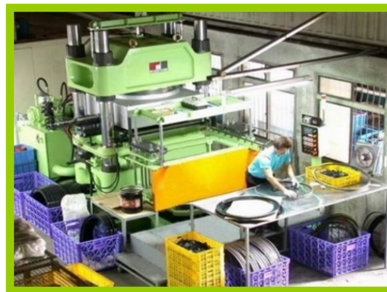
真空油壓加硫橡膠原料與鐵殼相結合
